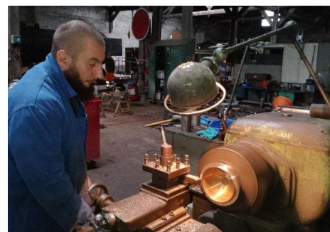
Tournage du corps de manomètre
