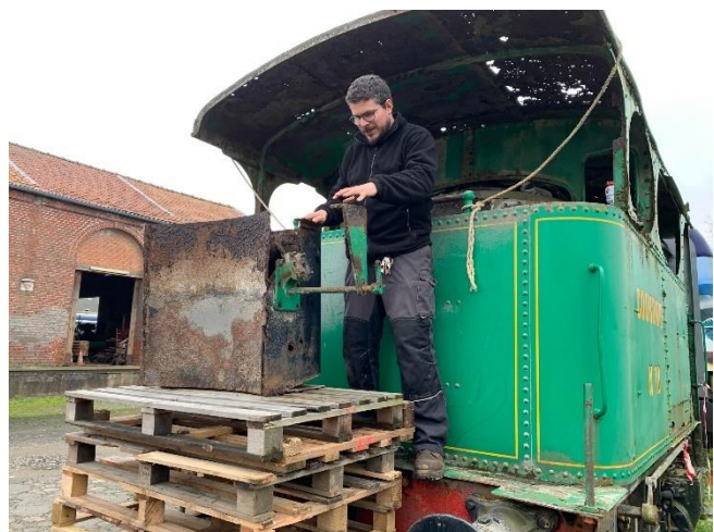
Démontage de la sablière
